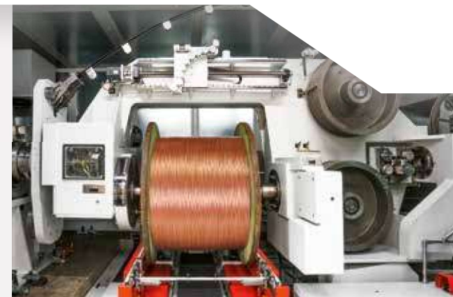
Bild 4. Eine weitere Besonderheit sind die energiesparende Einbügel-Bauweise und das NBAT-Verlegesystem
