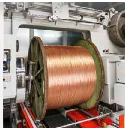
Bild 3. Die D 2002 nimmt Spulen mit 2 m Flanschdurchmesser auf
