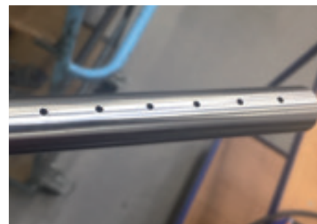
图8 拉丝模喷淋的新喷淋管路
