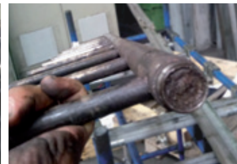
Bild 4. Mit Kupferschlamm verstopftes Besprührrohr der Ziehsteinbesprühung.
