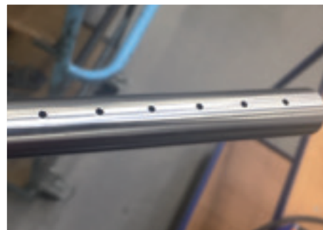
Bild 8. Neues Besprührohr der Ziehsteinbesprühung.
