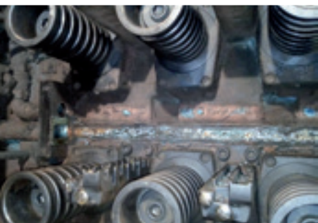
图1 运行65000个小时后的一台MMH拉丝部分。
