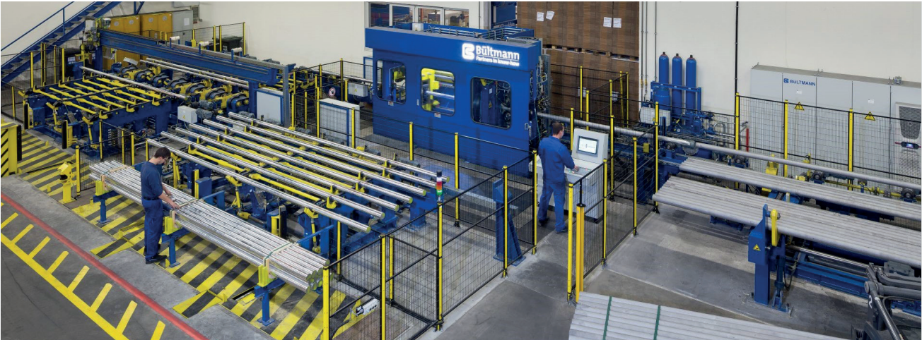
▲ Bültmann Schälanlagen für Aluminiumstangen sind speziell auf die anspruchsvollen Zerspanungskriterien von Aluminium ausgelegt.
